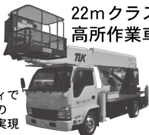
3 t クラスの小さなボディでクラス最大の作業範囲を実現
