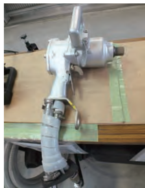
左写真／護岸工事で大活躍の水中エアインバクトレンチ。上写真／ウェルポイントポンプ。水気の多い現場で一時的に施工範囲の地下水位を下げる吸引装置。
