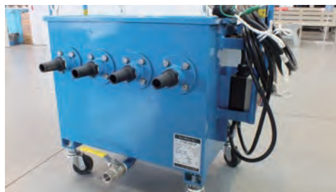
左写真／護岸工事で大活躍の水中エアインバクトレンチ。上写真／ウェルポイントポンプ。水気の多い現場で一時的に施工範囲の地下水位を下げる吸引装置。
