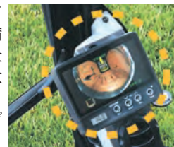
後方視界270度を達成し、巻き込み・挟まれ事故を大幅に削減するFVM
