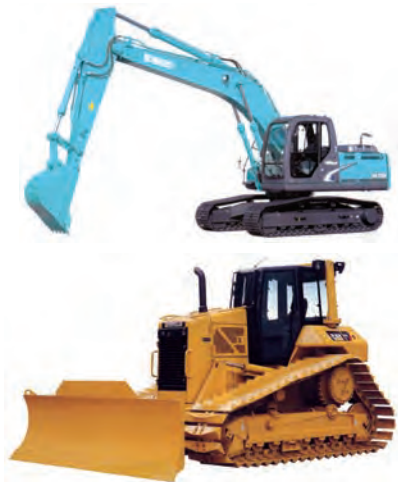
大型重機を手配し駆けつけた東リースは心強い援軍だった。上・油圧ショベル。下・ブルドーザ
