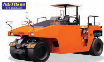
看板商品の振動ローラ（上）とタイヤローラ。震災復旧で存分に性能を発揮した
